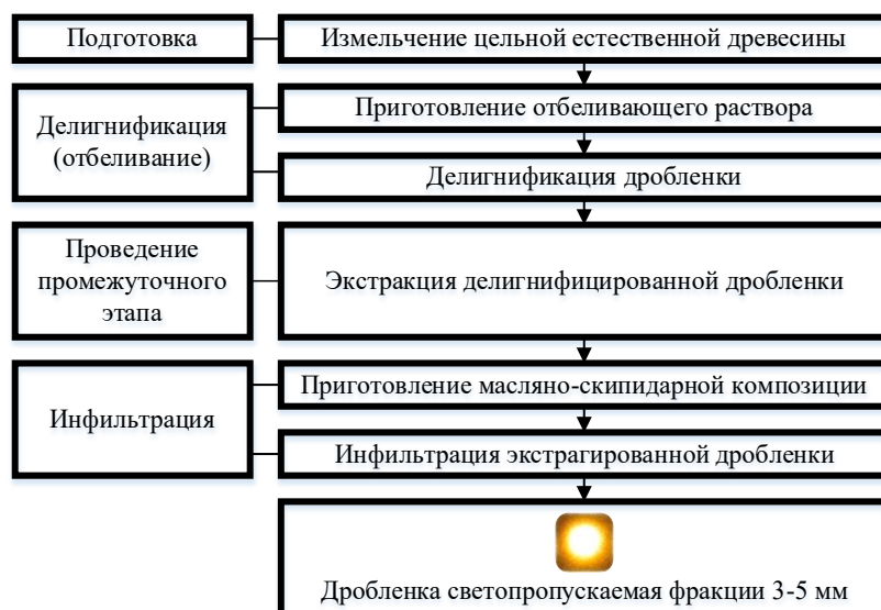
Рисунок 3.16 – Алгоритм для получения древесной дробленки светопропускающей фракции 3-5 мм
