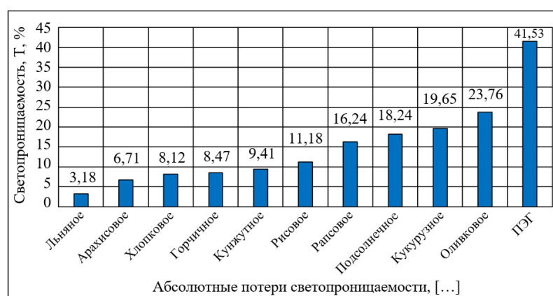
Рисунок 3.9 – Влияние растительных масел на светопропускание древесины
