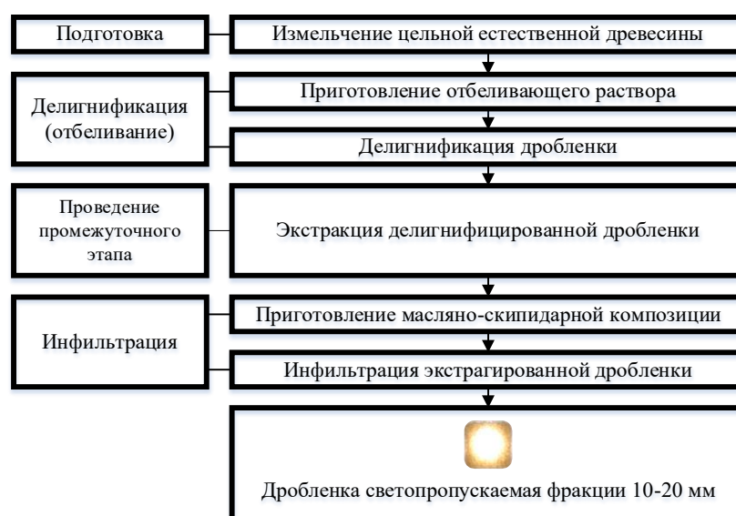
Рисунок 3.14 – Алгоритм для получения древесной дробленки светопропускающей фракции 10–20 мм
