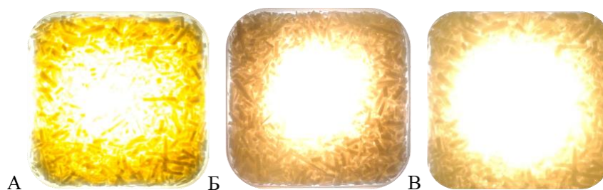
Рисунок 4.12 – Характер изменения светопропускания декоративных бетонных образцов на делигнифицированной древесине березы при пропитывании и пропитывании с термопрогревом: А – пропитывания растительным маслом; Б – тем же, со скипидаром; В – то же, с термопрогревом в течение 30 минут при температуре 75 °С
