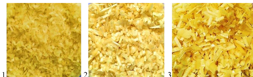
Рисунок 3.14 – Древесный отбеленный заполнитель разного гранулометрического состава для декоративного бетона:
