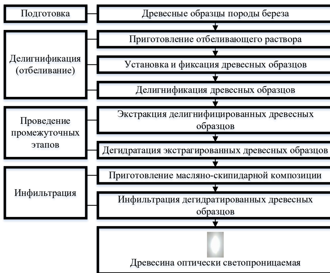
Рисунок 3.13 – Алгоритм для получения цельной древесины оптически светопроницаемой
