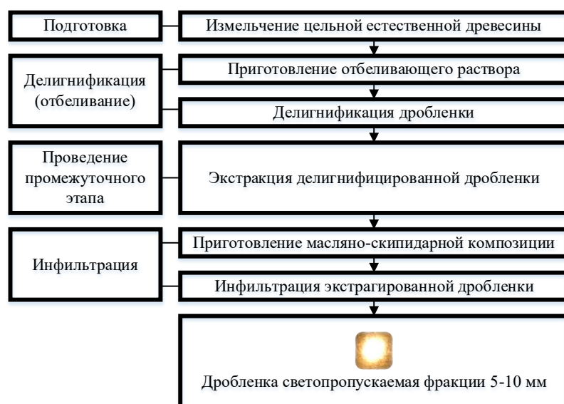
Рисунок 3.15 – Алгоритм для получения древесной дробленки светопропускающей фракции 5-10 мм
